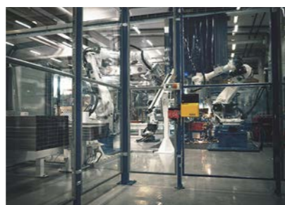
PANELES DE POLICARBONATO Ofrecen buena visión general y protegen contra fluidos y partículas pequeñas.
