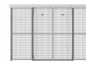
PORTE COULISSANTE DOUBLE RAIL SIMPLE 1400-3000 mm
