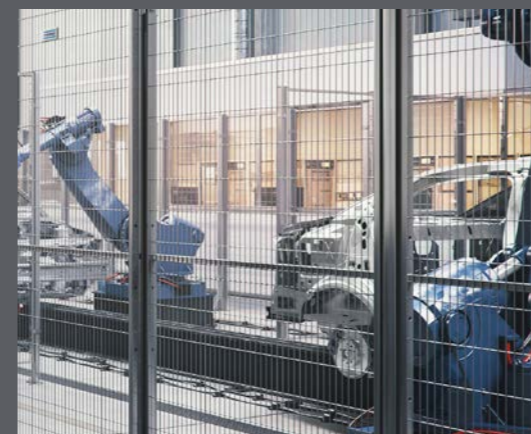
TUBES PROFILÉS UNIQUES Les tubes horizontaux de nos panneaux grillagés ont un profilé unique conçu pour rendre la soudure plus solide et la maille plus plate.
