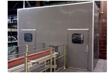
VOLLBLECH Die Vollblechelemente werden vor allem zum Schutz bei Schweiß- und Schneidemaschinen eingesetzt.
