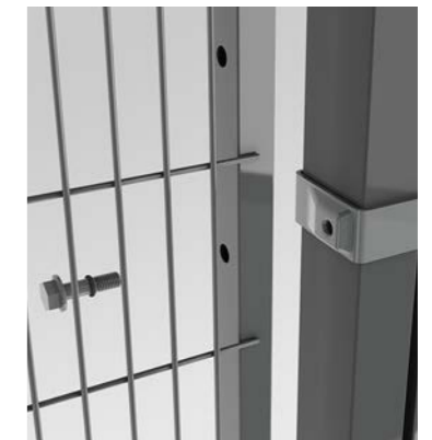
SMART FIX KLAMMER In Position gehalten durch einen Bolzen auf der Rückseite der Klammer. Für eine Eckinstallation bewegen Sie den Bolzen in die Seitenposition.
