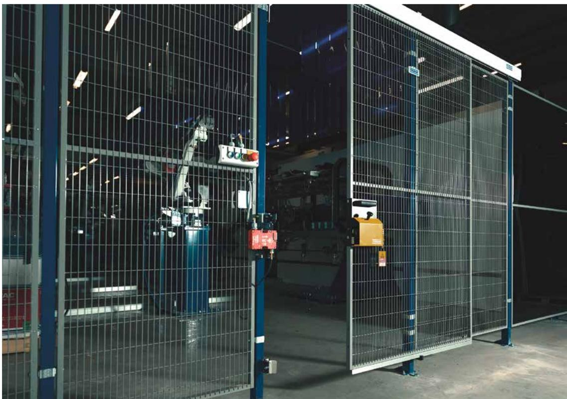
常に現場の安全のために。TROAXのセーフロック、ユーロシリンダーロック、マグネティックロック、セーフエスケープロックは、多様な安全スイッチと組み合わせて利用できます。
